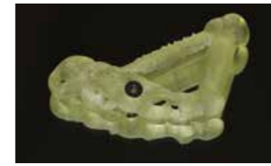
Guide de chirurgie pilotée imprimé en résine nextdent SG / Pilot drill guide
